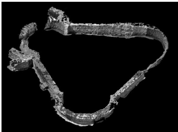
fig. 5 – Modello 3D. Vista assonometrica della nuvola di punti relativa alla Sala Triabsidata.
